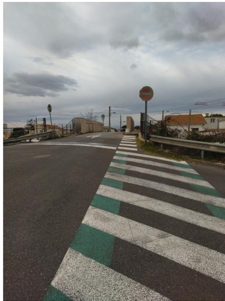
*Figure 7: Peinture sur chaussée, étroite et qui nous mène dans le mur à droite en haut, alors qu'on veut tourner à gauche.*
